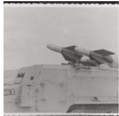
1960 - טיל SS-11, "תגר" בשמו הצה"לי, בעת שיגור מזחל"מ. הטיל השמאלי בשנייה שבה המנוע הופעל
